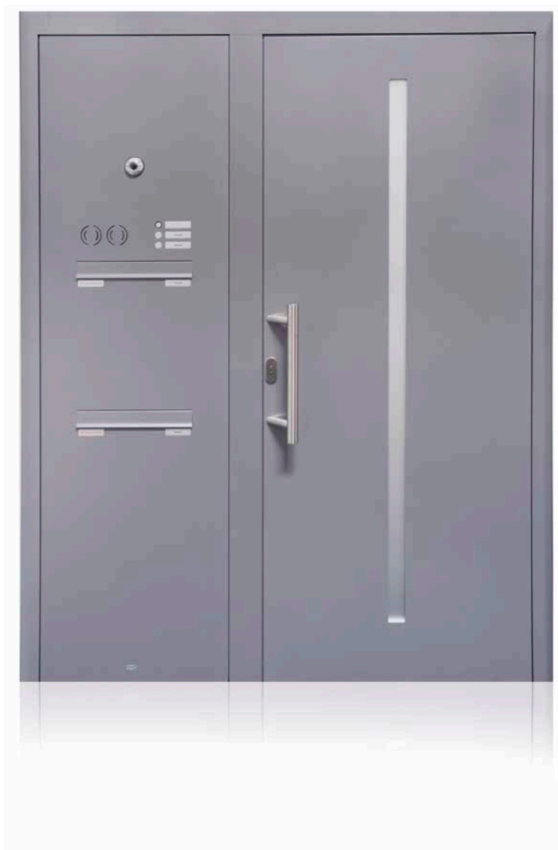
Abb. 1 Türseitenteil-Anlage aus hochwertigem Galfan-Stahl, Front flügelüberdeckend 35 mm dick mit thermischer Trennung, senkrechte Kästen, geräuschgedämpfte und wasserabweisende Einwurfklappe RSK, RSA2-Klingelsystem und Namensschild, vorge- richtet für bauseitiges Kamera-Modul.
