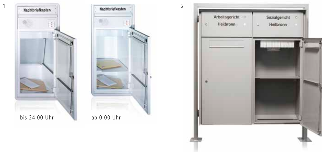
Abb. 1 Funktionsweise eines Tag-/Nachtbriefkastens, Unterputz-Anlage, mit rundem Putzabdeckrahmen RS3000, Tag-/Nachtumschaltung zur Fristenkontrolle, RSA1-Sprechfeld, Kunststoff-Klingelmodul, farbig ausgelegte Eingravur. Abb. 2 Tag-/Nachtbriefkasten mit beweglicher Fingersperre als Entnahmesicherung, enganliegende aufgefütterte Verkleidung, Rechteckrohrgestell 80 x 40 mm, Sonder-Einwurfklappe, RSA2-Klingelsystem, 3-Punkt-Verriegelung, farbig ausgelegte Eingravur.
