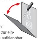
Die Frontplatten sind ringsum 30 mm überstehend, mit den Kästen verschraubt und zur einfachen Montage der Anschlüsse teilweise aufklappbar.
